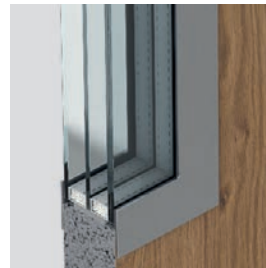
Prosklení – trojskelná sada třída P4
